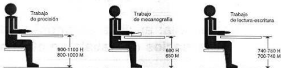
Fig. 1: Altura del plano de trabajo para puestos de trabajo sentado (cotas en mm)
